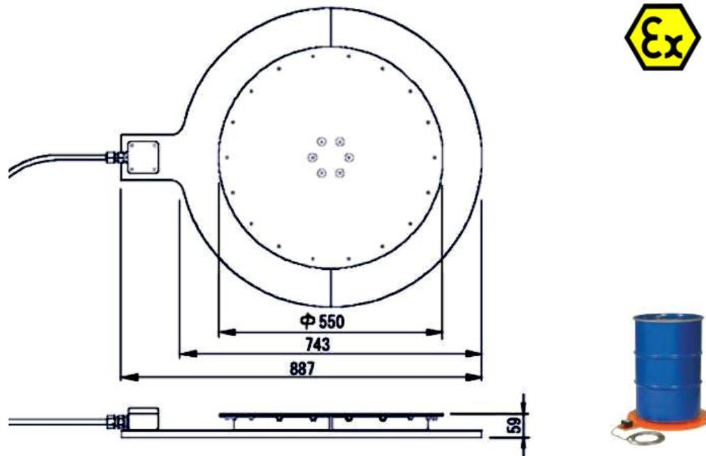
L'embase chauffe fûts convient pour tout chauffage jusqu'à 205 litres. Le fût peut être en plastique, acier ou acier inoxydable. A utiliser seul ou en complément d'autres produits de notre gamme.
