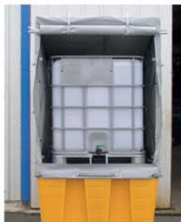
Ce système s'adapte sur le bac de rétention pour un stockage en extérieur. Sa structure est en acier galvanisé démontable, la fixation sur les tubes se fait par bande velcro. Le rideau avant est relevable. Il est livré en kit.
