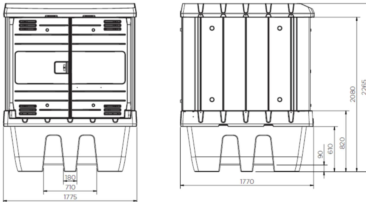
L'ensemble de nos produits est fabriqué en polyéthylène insensible à la corrosion et à de nombreux produits chimiques.
