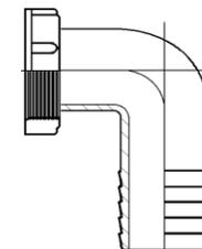
S'adapte à la sortie basse du conteneur sur les vannes avec sortie M2" Pas du gaz (BSP) et permet de transvaser en toute sécurité et à volonté le liquide qu'il contient.
